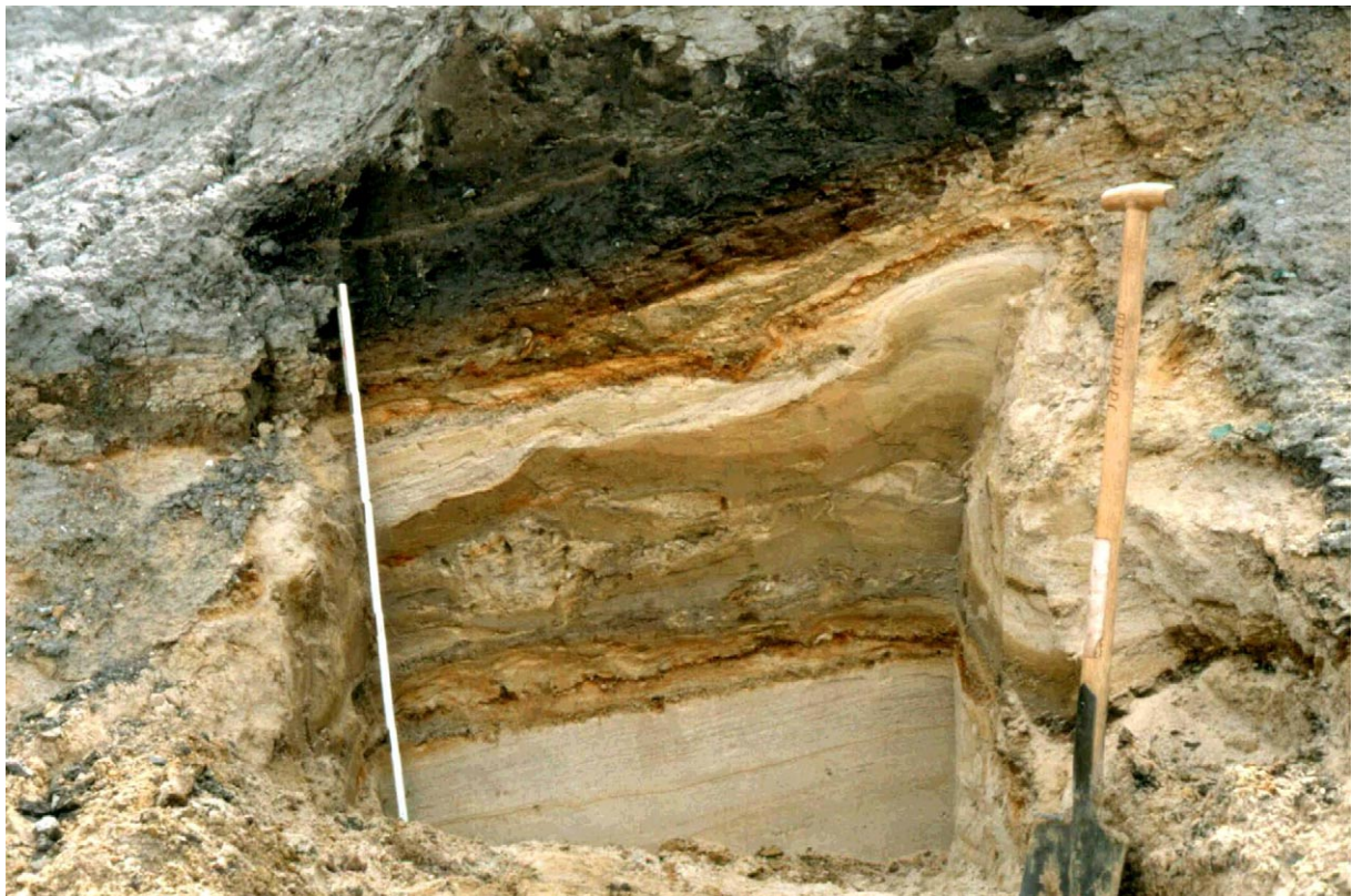
Abb. 100: Gestörte Grobschluffe und Sande im Liegenden des unteren Geschiebemergels (Tongrube Glienick)
