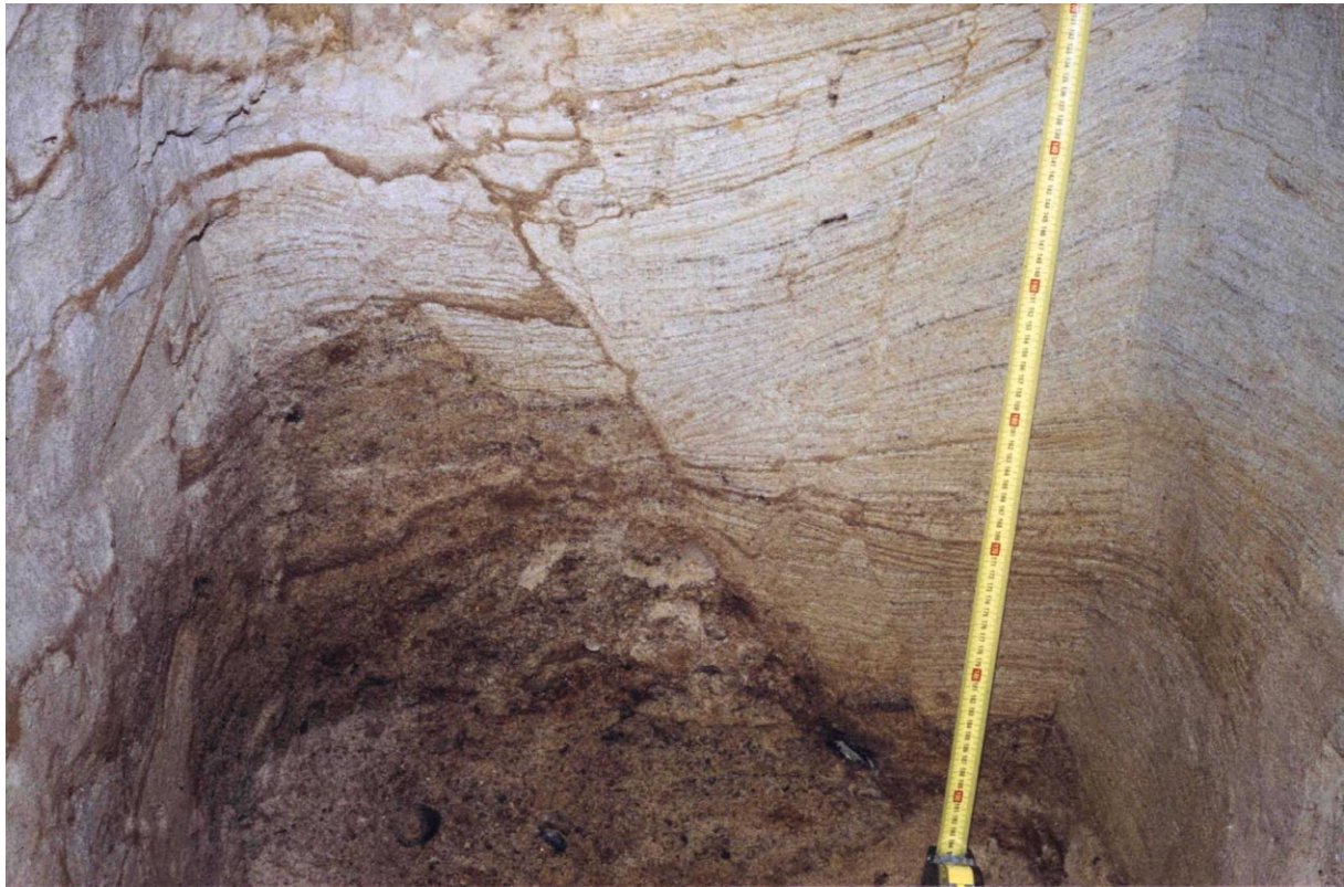
Abb. 42: Durch Abschiebungen gestörte Sande und Kiese im Schurf ADQ6
